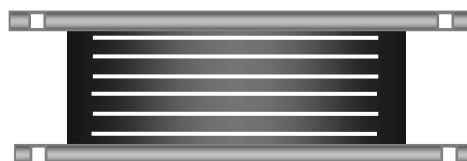
Рисунок 5.1 - Опорная часть из натуральной или синтетической резины
